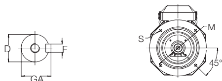
Foot-mounted motor IM 1001, IM B3
